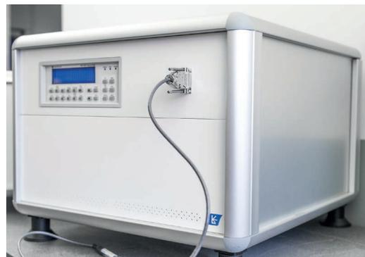
出于这个原因，提供镍合金屏蔽以确保减少外部影响到可以忽略不计的水平，允许准确测量Hc低于几A/m。
